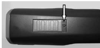
III. 4 Interruttore a scorrimento in posizione OFF ("0")
