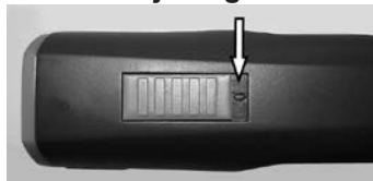
III. 4 Skyvebryter i AV-posisjon ("0")
