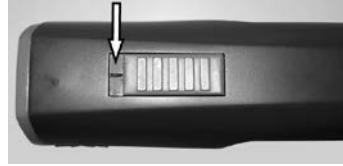
Kuva 5 Liukukytin ON-asennossa ("I")
