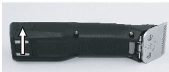
III. 8 Sperre batteri
