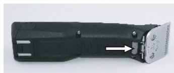
Fig. 7 Verrouillage de tête de coupe
